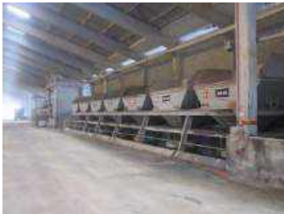
Figura 3.25: Detalhe das moegas automáticas das Misturas 3 e 4
