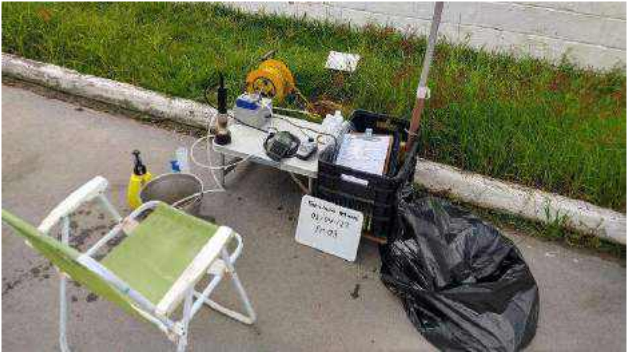
Figura 1: Amostragem e coleta de água subterrânea por baixa vazão (PM-03).
