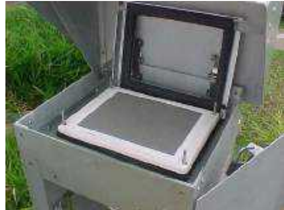
Figura 4.1.2.4-14: Vista do tampo aberto destaca o filtro. Após a coleta, o filtro fica cinzento ou castanho
