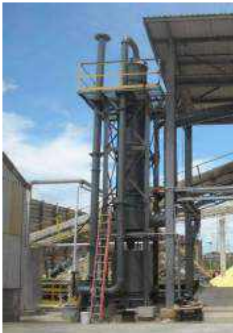
Figura 2.2.5.2-11: Vista geral do dessublimador instalado para controle de emissões de gases na fusão de enxofre
