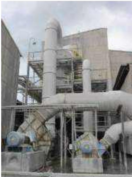
Figura 2.2.5.2-35: Vista geral do lavador de gases da Granulação. Lavador do Granulador, do Secador e respectivos exaustores
