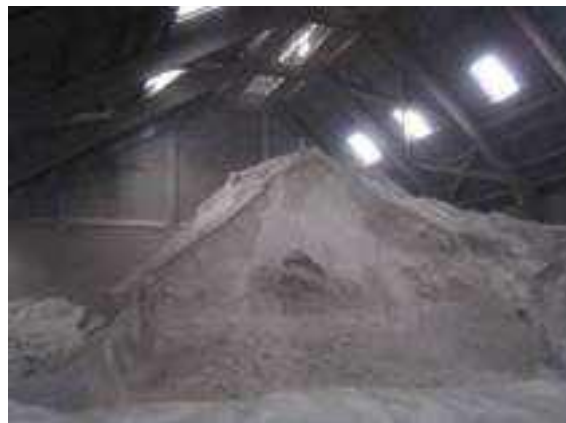
Figura 2.2.3.2-10: Produto (Superfosfato Simples Pó - SSP) depositado no armazém de cura para consumo
