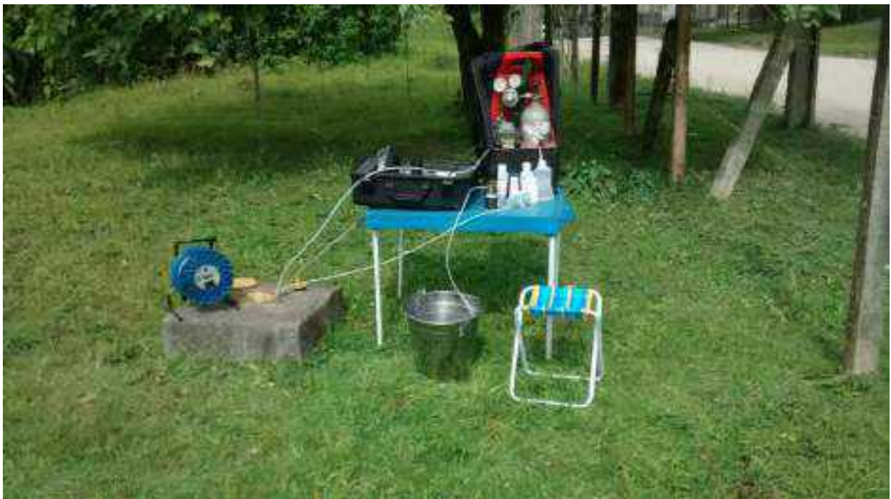
Figura 4: Amostragem e coleta de água subterrânea por baixa vazão (PM-05).
