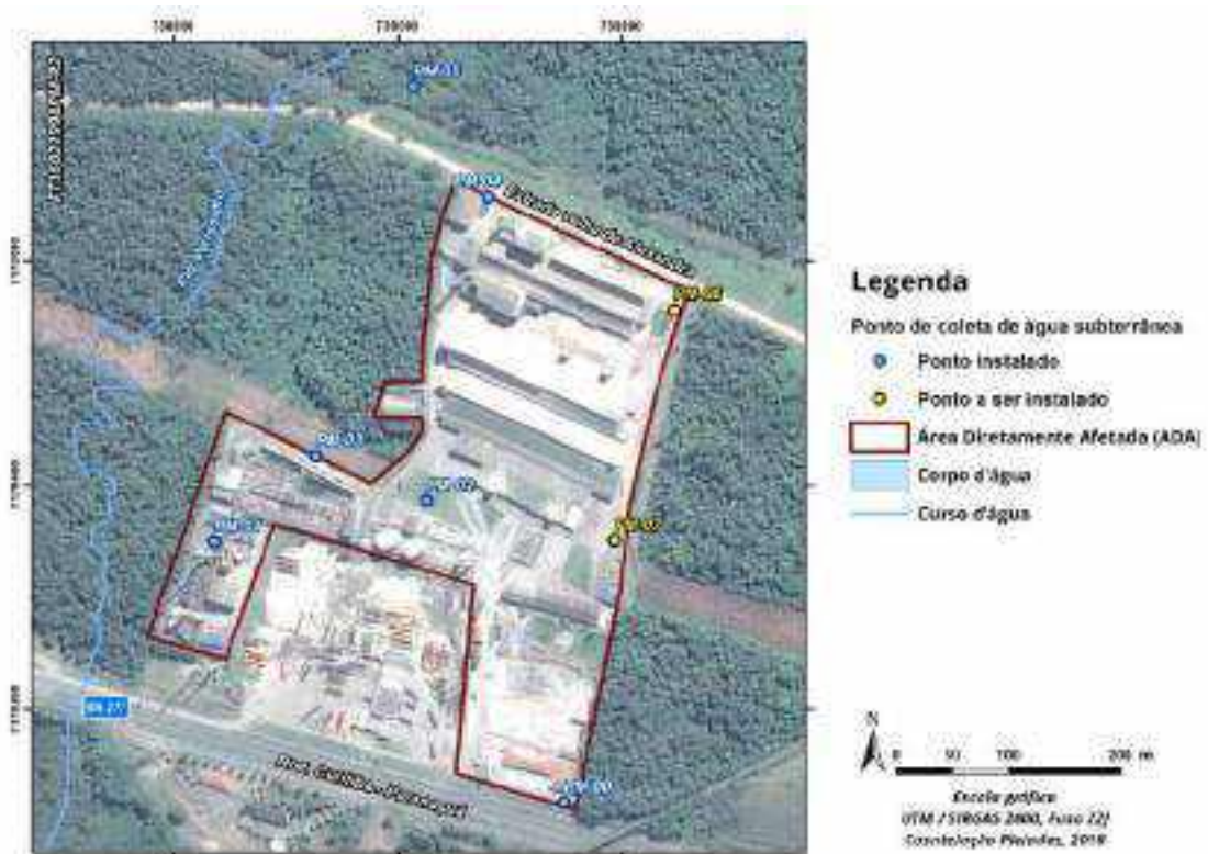
Figura 5.4.1.4-4. Localização dos seis poços de monitoramento existentes e em dois novos poços onde serão feitas as amostragens de águas subterrâneas
