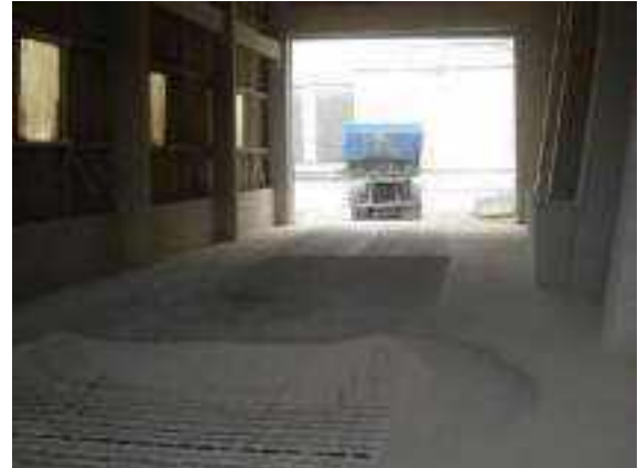
Figura 2.2.3.2-2: Vista da moega de descarga de rocha
