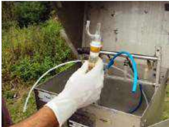
Figura 4.1.2.4-15: Vista da retirada da solução da análise de SO 2
