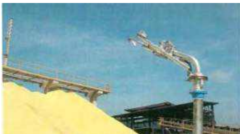
Figura 71 - Sistema de Sparger que aplica o efluente da caixa de correção de pH sobre a pilha de enxofre.
