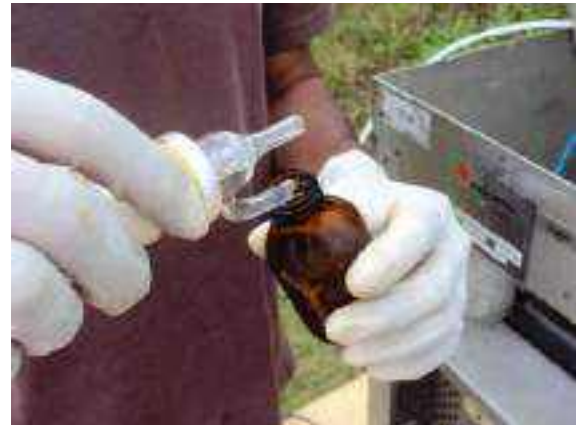
Figura 4.1.2.4-16: Vista da transferência da solução de SO 2 para o frasco
