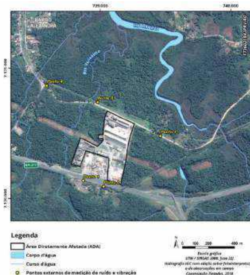
Figura 4.1.5-1: Localização dos pontos de medição de ruído e vibração
