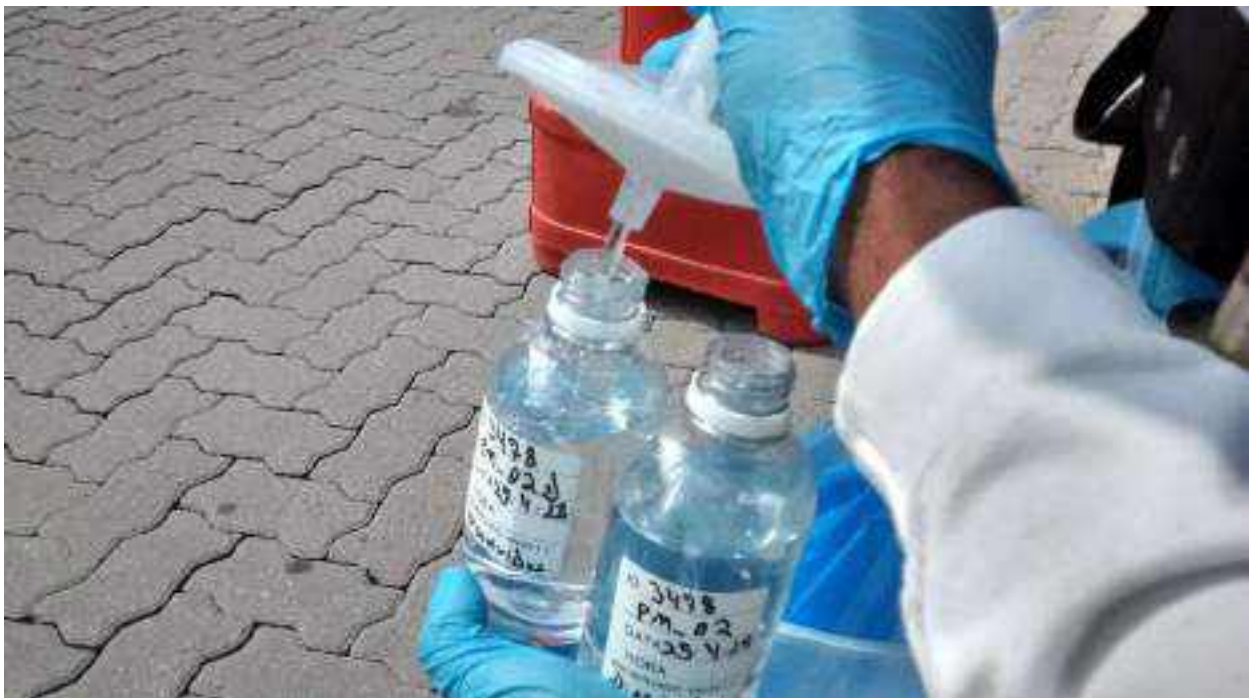
Figura 6: Amostragem de água subterrânea para análise de metais dissolvidos no poço PM-02.
