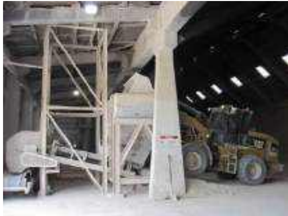
Figura 2.2.3.3-1: Vista da alimentação da moega de matérias primas da granulação via pá carregadeira
