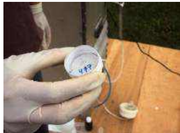
Figura 4.1.2.4-18: Vista do filtro para análise de fluoretos particulados
