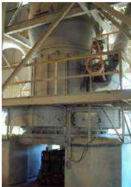
Figura 2.2.3.2-7: Vista do moinho de rocha fosfática.
