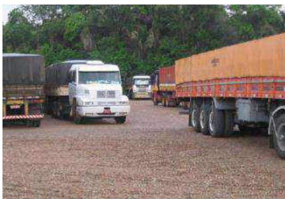
Figura 2.2.5.2-44: Vista do pátio de caminhões com camada de brita para controle de emissões de poeiras
