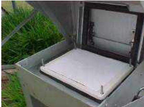
Figura 4.1.2.4-13: Vista do tampo aberto destaca filtro que captura o PTS. Antes das coletas, o filtro está branco
