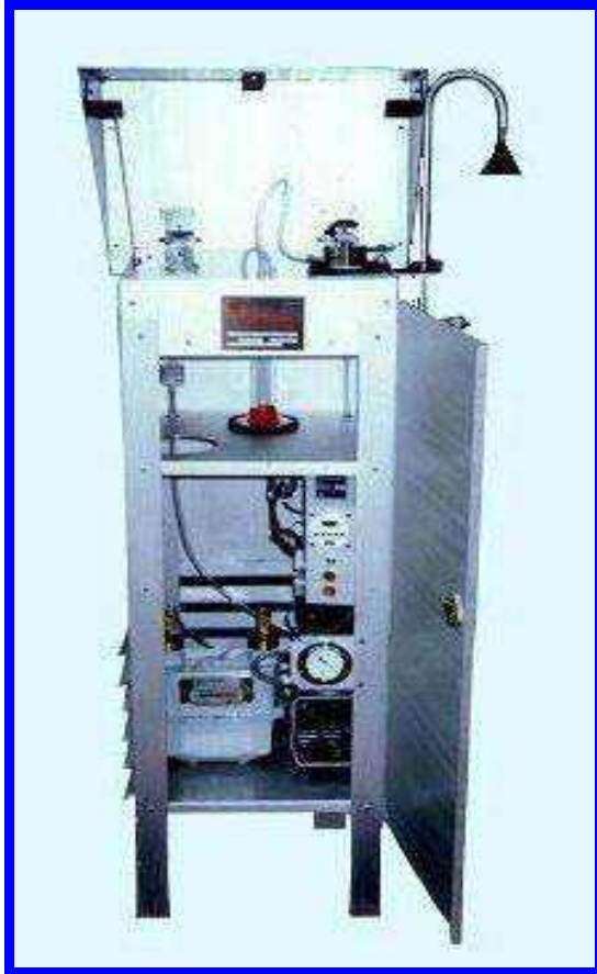
AMOSTRADOR DE FUMAÇA E SO 2 (OPSOMS)
